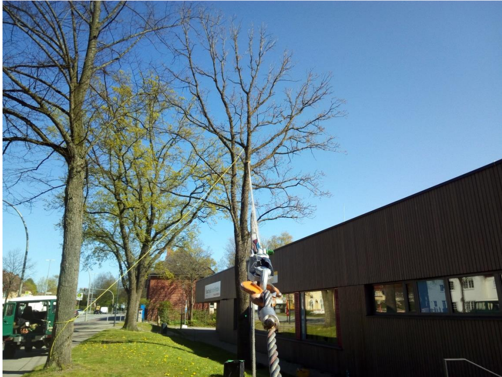
Versuchsbaum mit Zugseil und Kraftmessdose.
